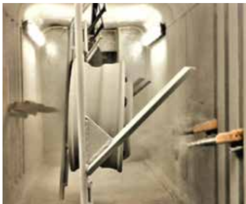
شکل ۱: نمای کلی خط رنگ پودری و گان های رباتیک داخل کابین پاشش
