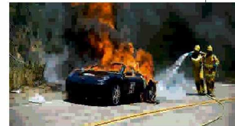
چالش اصلی امروزه باتری های لیتیوم یون مورد استفاده در خودروهای الکتریکی موضوع اینها می باشد. الکترولیت مرسوم مورد استفاده در باتری های امروزی حلال های آلی هستند. این حلال ها دارای خاصیت اشتعال پذیری بالایی در مجاورت اکسیژن موجود در محیط می باشد.
