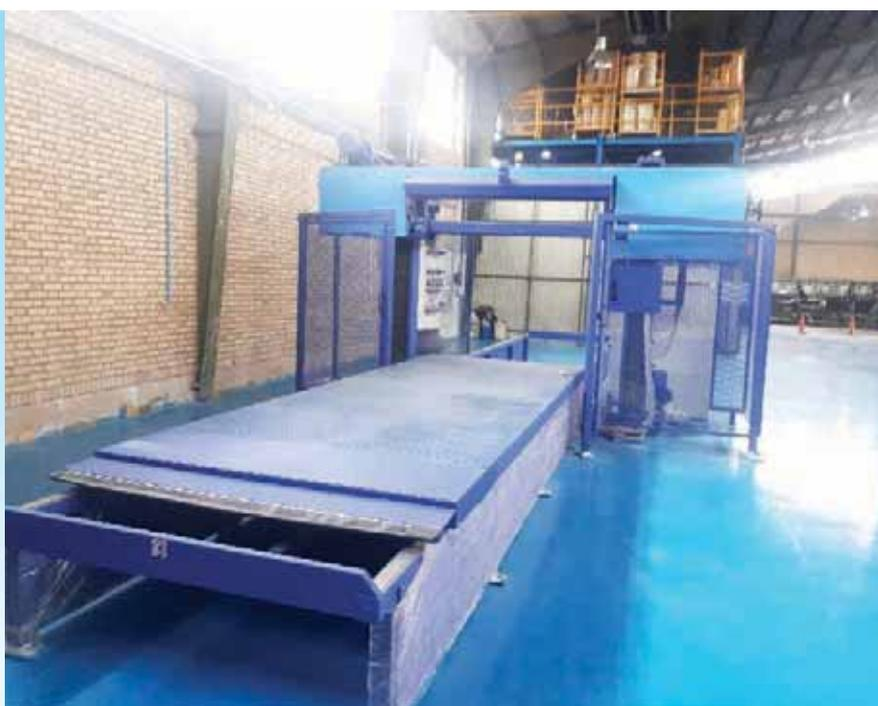
توسط چسب انجام می گردد و پس از قرار گیری لایه ها بر روی هم، مجموعه از طریق اعمال همزمان فشار و دما یک شکل هندسی ۳ بعدی حاصل می شود. سقف کاذب در سالن تزیینات در خط خودرو ساز مونتاژ شده و پس از نصب کلیه چراغهای داخلی خودرو، دستگیره و آفتاب گیرها روی آن مونتاژ می شوند.
